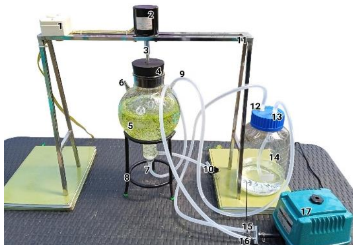
Gambar 2. Alat bioreaktor termodifikasi untuk perbanyak anggrek secara klonal (Restanto et al., 2023)
