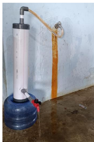
Gambar 4. Aplikasi Filter Air Menggunakan Arang Aktif di TPS 3R di Samarinda
