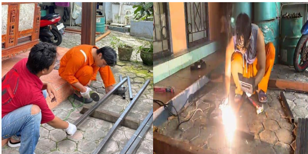
Gambar 3. Pemotongan besi dan las struktur tempat sampah
