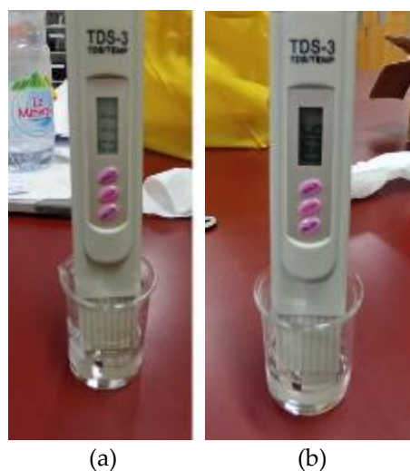
Gambar 11. Hasil pengukuran TDS air hujan yang ditampung (a) sebelum di-filter, (b) setelah di-filter.
