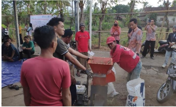
Gambar 5. Proses pencampuran sekaligus penggilingan bahan pembuatan pupuk organik.
