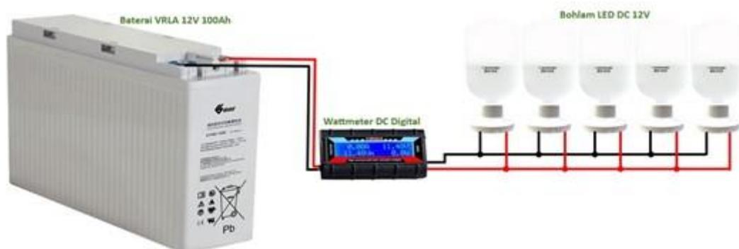
**Gambar 8.** Rangkaian Pengujian Lampu dc
