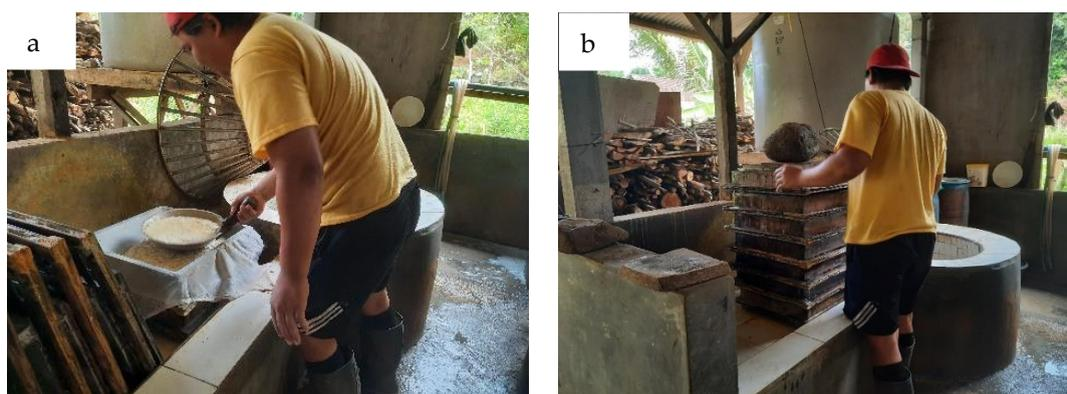
**Gambar 1.** UKM Tahu Ngaran (a) Proses menuangkan bahan tahu pada cetakan; (b) Proses pengepresan tahu dengan menggunakan batu
