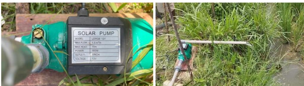
Gambar 7. Pompa Air DC Ketika Diimplementasikan Ke Lahan Sawah.
