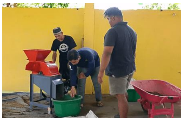
Gambar 3. Tim pengabdian mendemonstrasikan cara kerja mesin pencacah kotoran sapi.
