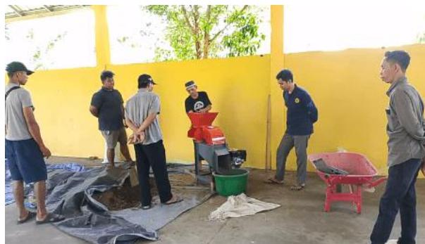
Gambar 5. Proses pencacahan kotoran sapi menggunakan mesin oleh peserta.
