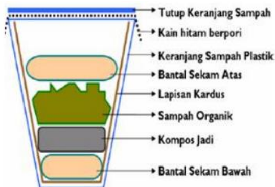
Gambar 2. Lapisan metode Takakura
