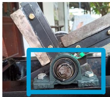
Gambar 7. Pengecekan Pillow Blok
