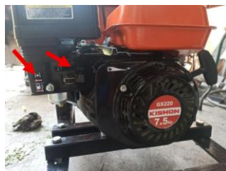
Gambar 10. Pengaturan chuck kekiri untuk membesarkan ketika menghidupkan mesin
