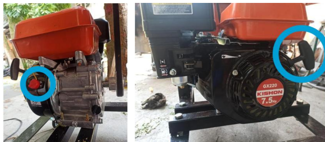
Gambar 12. (a) Posisi saklar ON, (b) Tuas penarik untuk menghidupkan mesin
