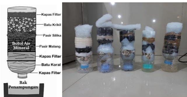
Gambar 4. Susunan material penyusun alat filtrasi air
