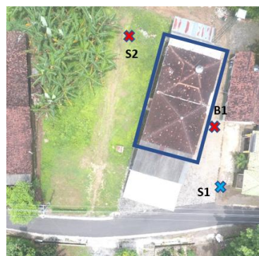
Gambar 2. Lokasi pengujian bor dan sondir (S=Sondir, B=Bor)
