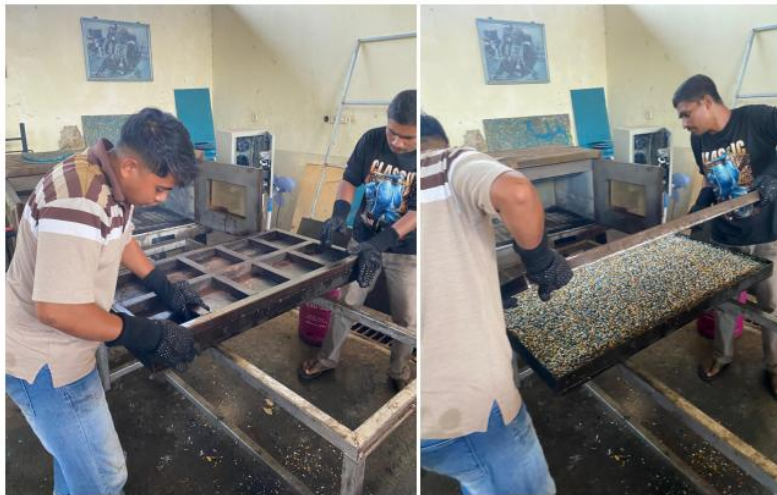
Gambar 4. Proses Pembentukan Papan Plastik
