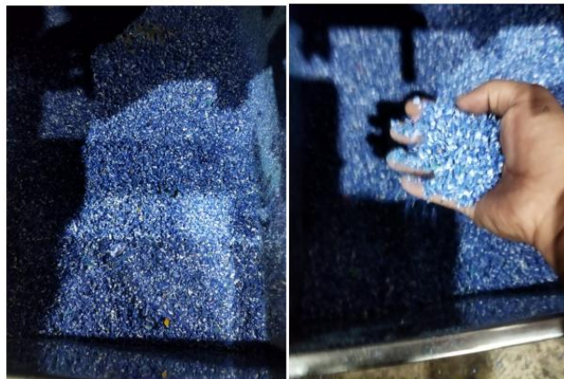
Gambar 2. Limbah botol dan tutup plastik yang sudah dicuci dan dicacah. Siap untuk dilebur jadi bahan baku papan plastik
