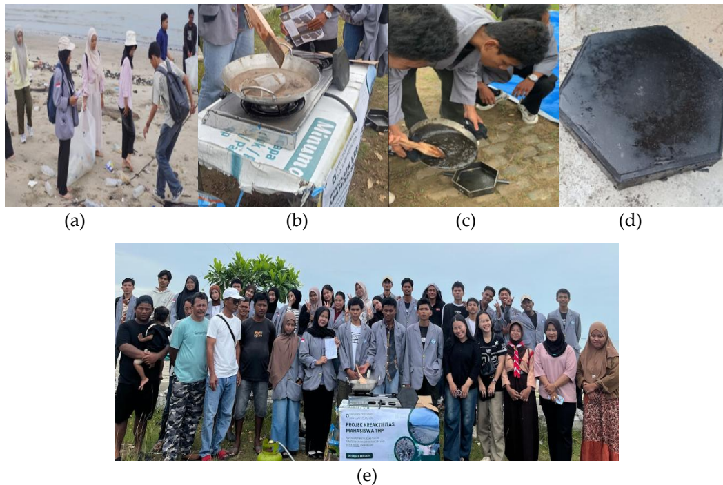
Gambar 2. (a) pengumpulan sampah plastik; (b) pencampuran dengan bahan perekat sambil dipanaskan; (c) pencetakan; (d) produk paving blok setelah kering; (e) peserta pelatihan dan tim pengabdian
