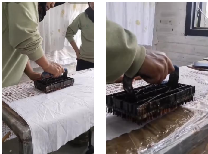
Gambar 3. Implementasi canting batik cap dalam proses produksi
