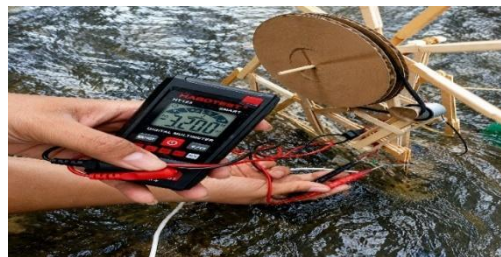
Gambar 4. Pengujian Prototipe HYDROWIND dan Pengukuran Tegangan Menggunakan Multimeter
