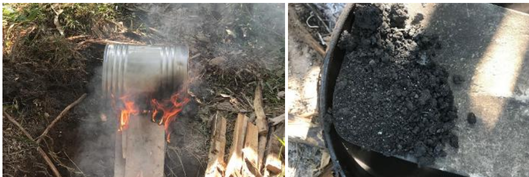
Gambar 4. Proses Pembakaran Limbah Kotoran Ayam dengan Tong dan Arang Hasil Pembakaran
