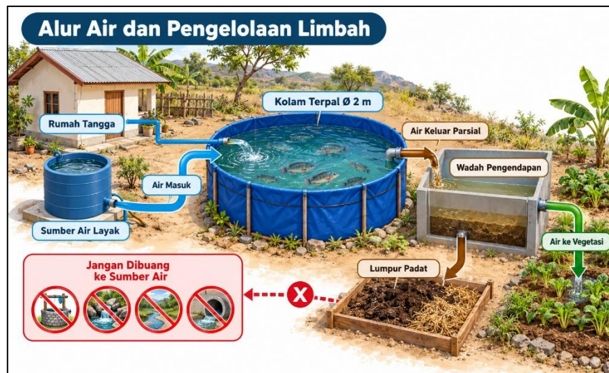
Gambar 1. Ilustrasi desain operasional model 1 Rumah 1 Kolam Protein serta mekanisme tata kelola air dan limbah
