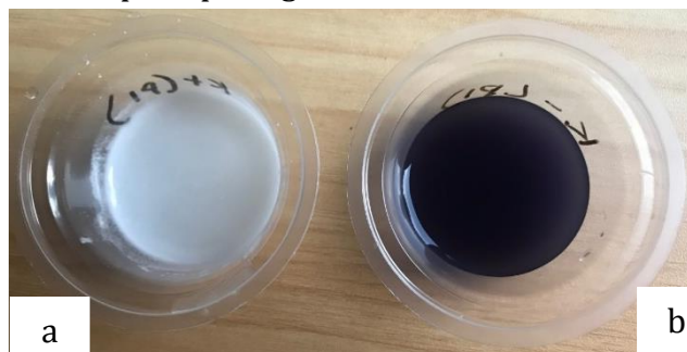
Gambar 1. Deteksi klorin pada sampel filtrat beras dengan povidon iodine (a). kontrol positif, (b) kontrol negatif.
