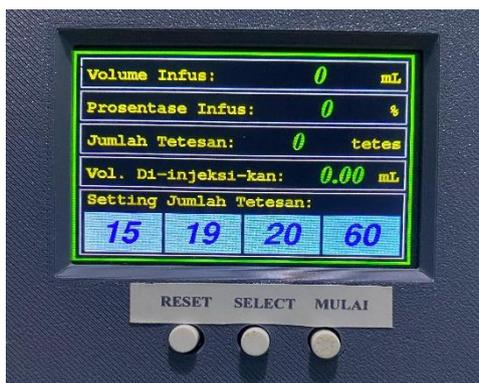
Gambar 5. Tampilan LCD TFT 3,5 Inch
