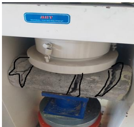
Gambar 6. Jenis kerusakan beton setelah uji kuat tarik belah
